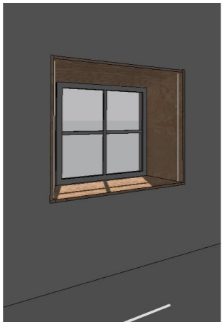
Détail 1: Chambranle, cadre finition bois, vue intérieur
