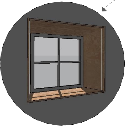
détail: chambranle de finition bois profondeur tableau env. 30 à 60cm (moyenne à 45cm)
